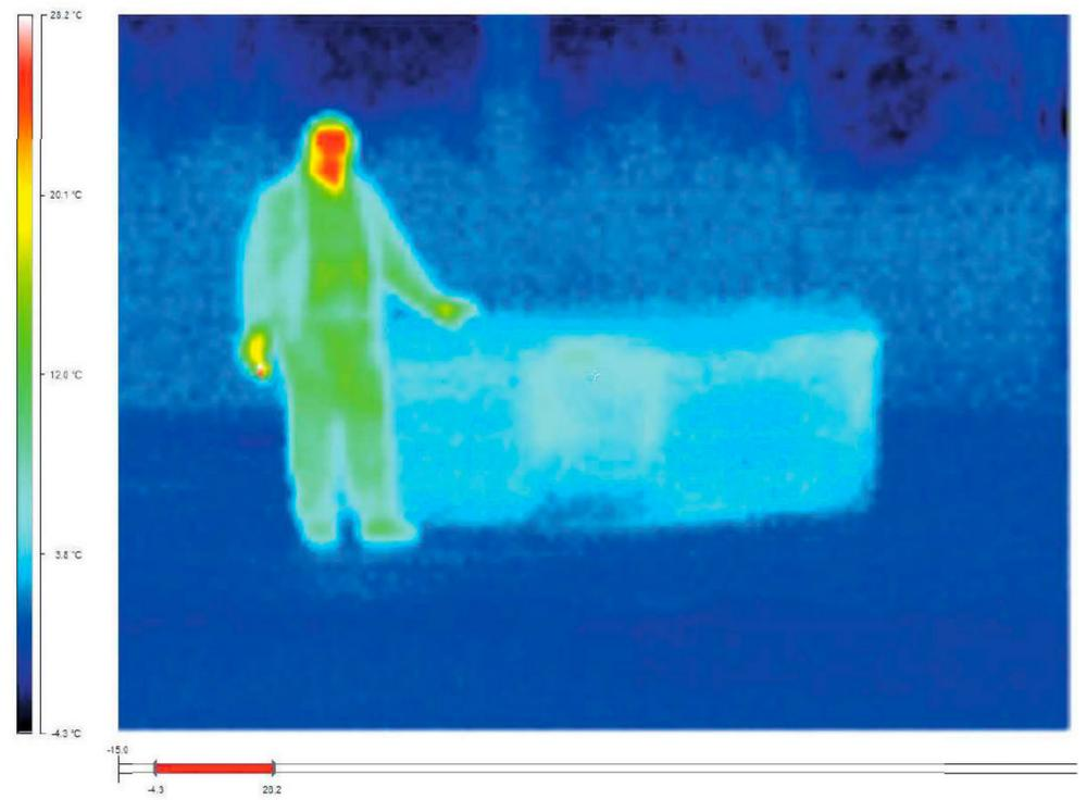
Eccellente risultato del test della mappa del calore. La temperatura dell'acqua nella Spa visibile dalla foto è di 35 °C, mentre quella esterna e quella della copertura isotermaica è 4°C .
